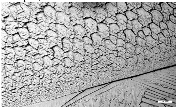
Рис. 1. Деформационная структура свинцового образца.(x2300)
