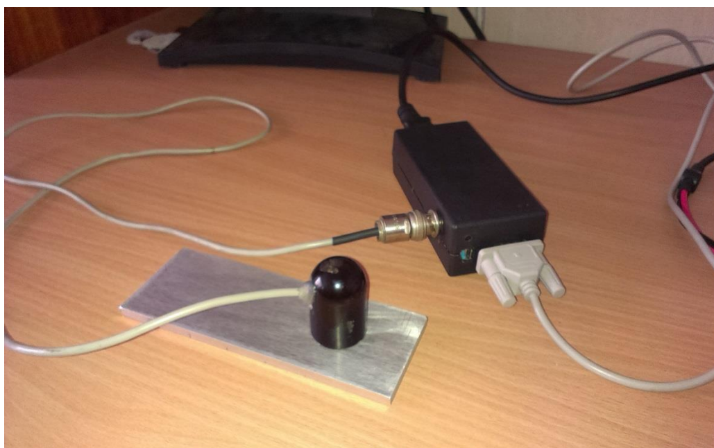
Рисунок 2.2. Внешний вид измерительного блока вихретокового устройства с накладным параметрическим датчиком.
