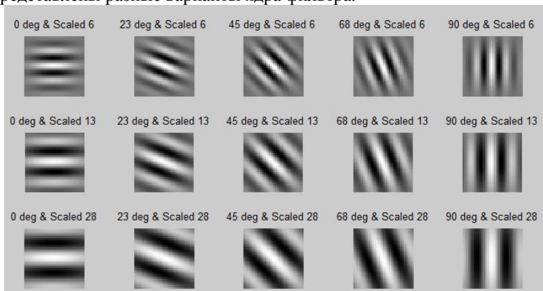
Рис. 3. Маски фильтра Габора одной размерности и разных параметров
