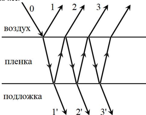
Рис. 2. Многолучевая интерференция в тонкой пленке
