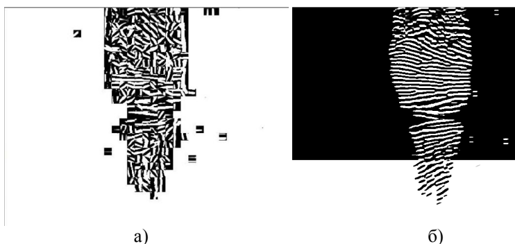
Рис.5. Поблочное применение фильтра Габора с подсчётом угла методом PCA: а) блоки размером 16х16, б) блоки размером 240х320
