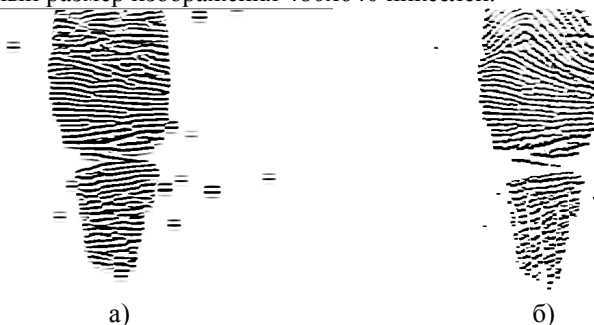
Рис. 4. Результат применения фильтра ко всему изображению: а) с маской размерностью 21х21 пиксель, б) - размерностью 5х5 пикселей.
